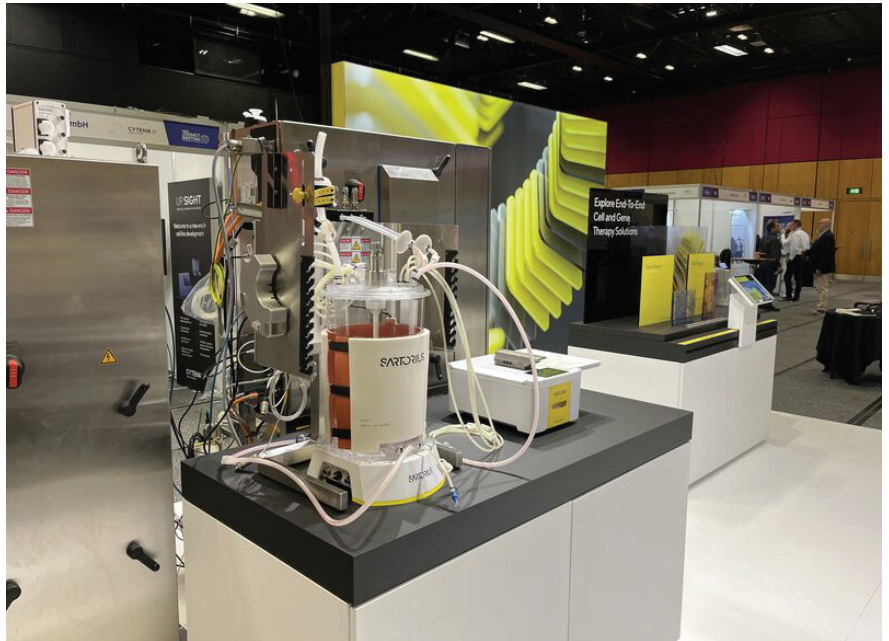
図 4 ヒートジャケットが一体的に取り付けられた Univessel® SU.
