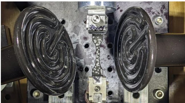
図4 この実験装置は、2つの黒色セラミックヒーター間でリチウム（中央、黒色で銀色の点がある部分）を引張試験するものです。
