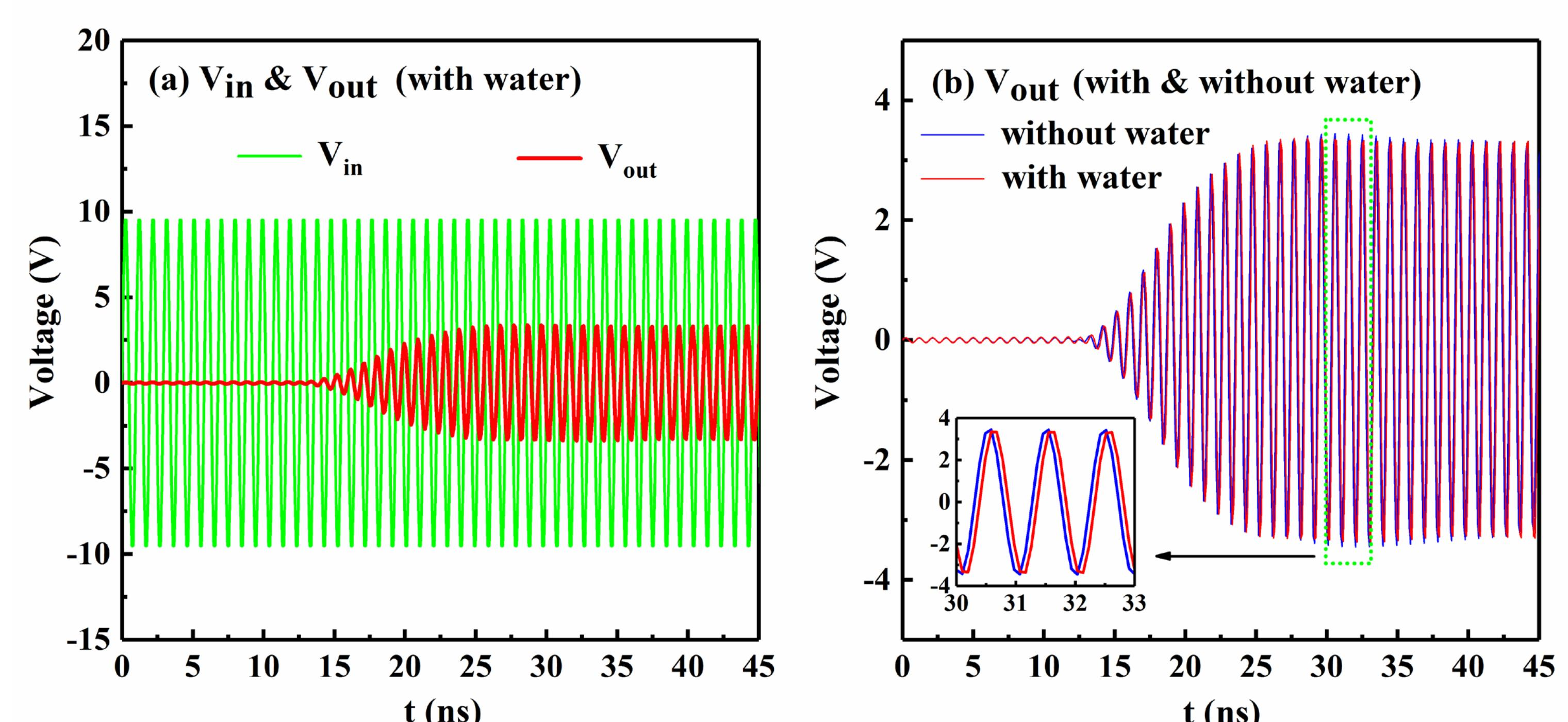
图5. (a) 正弦激励信号与输出响应信号及(b) 添加液体前后输出信号的变化
