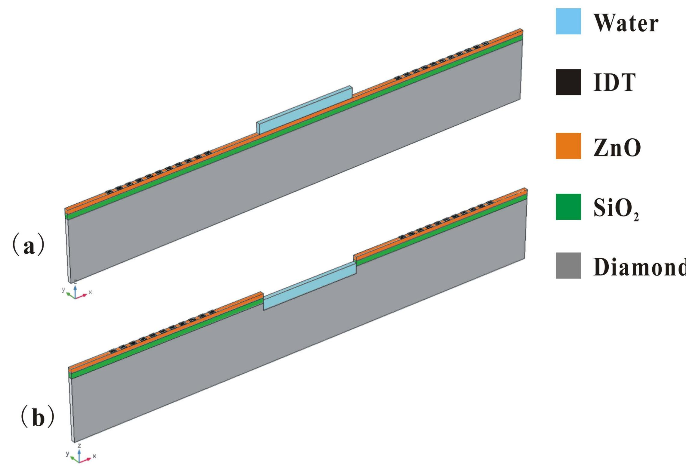
图1. IDT/(100)ZnO/SiO<sub>2</sub>/Diamond器件中两种微腔结构示意图:
