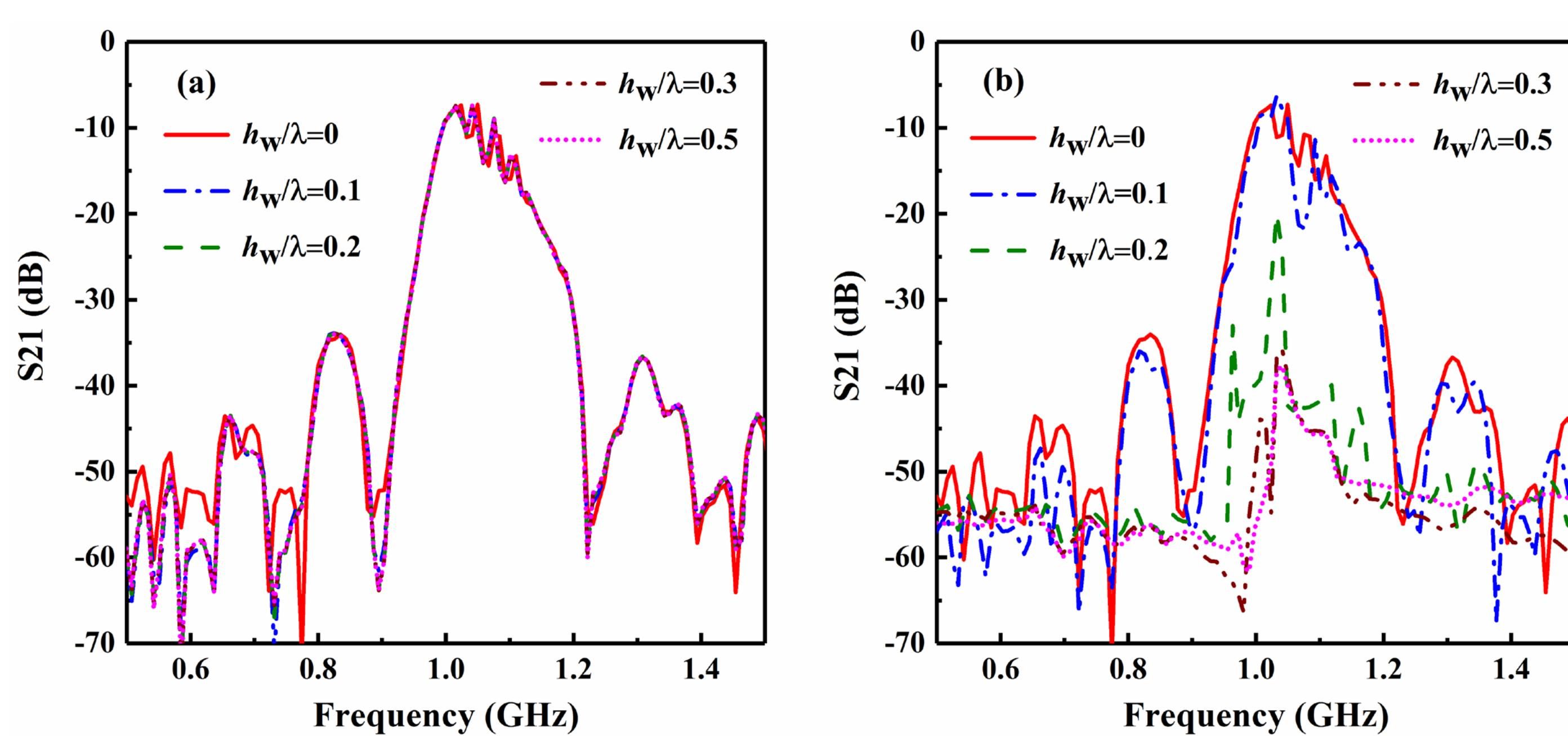
图2. Love波器件插入损耗S21随液体深度的变化
