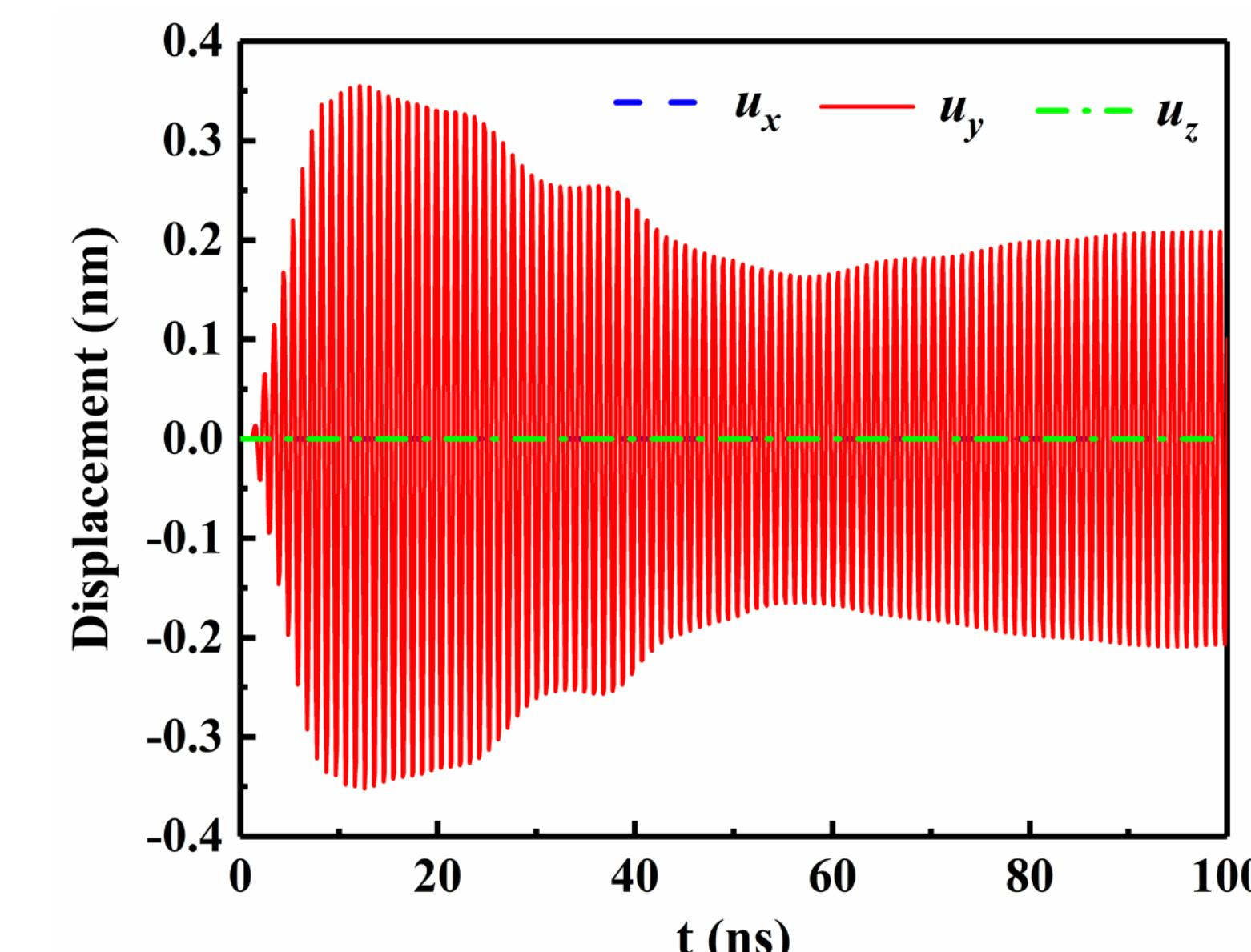
图3. 基片表面声波位移分量随时间变化曲线
