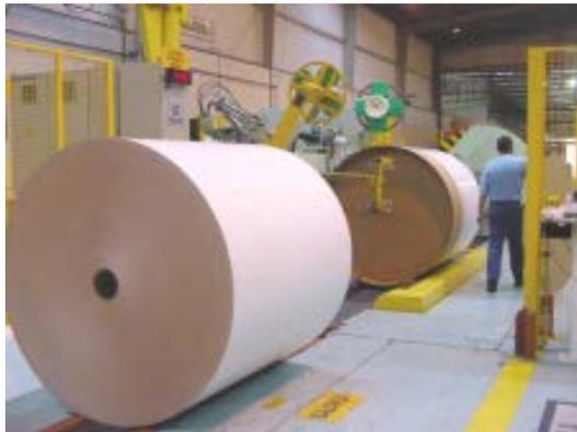
Figura 3: A bobina jumbo é cortada em bobinas menores.
