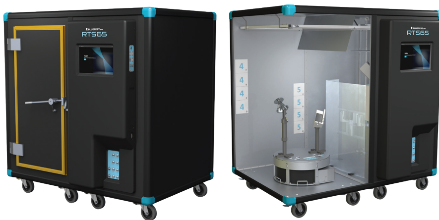
図1 RTS65として知られる Bluetest の残響テストシステムの1つの例。Bluetest は現在、5つの異なるRTSを市場に出しています。
